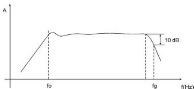
Slika 25: Frekvencijska karakteristika zvučnika
